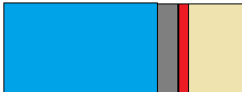
Figura 9 Modelo para o calculo de transferência de calor do reservatório principal. Azul é o interior com fluido de trabalho, a região cinza é a parede do reservatório, a vermelha representa o aquecedor e a bege o isolamento térmico
